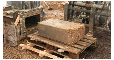
Beim ersten Pilotversuch im Maßstab 1:4 gepresster Block aus Recycling-Wellerlehm-masse eines thüringischen Gebäudes von 1711. Foto Ute Reeh
